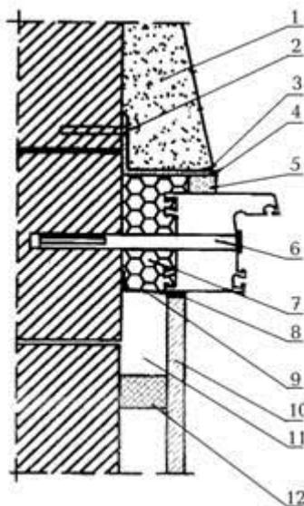
1 – штукатурный слой наружного откоса (с фаской для слоя герметика); 2 – строительный шуруп; 3 – герметик; 4 – фальшчетверть из уголка; 5 – изоляционная саморасширяющаяся паропроницаемая лента; 6 – рамный дюбель; 7 – пенный утеплитель; 8 – герметик; 9 – пароизоляционная лента; 10 – элемент отделки внутреннего откоса; 11 – полость, которая может быть заполнена теплоизоляционным материалом; 12 – рейка
