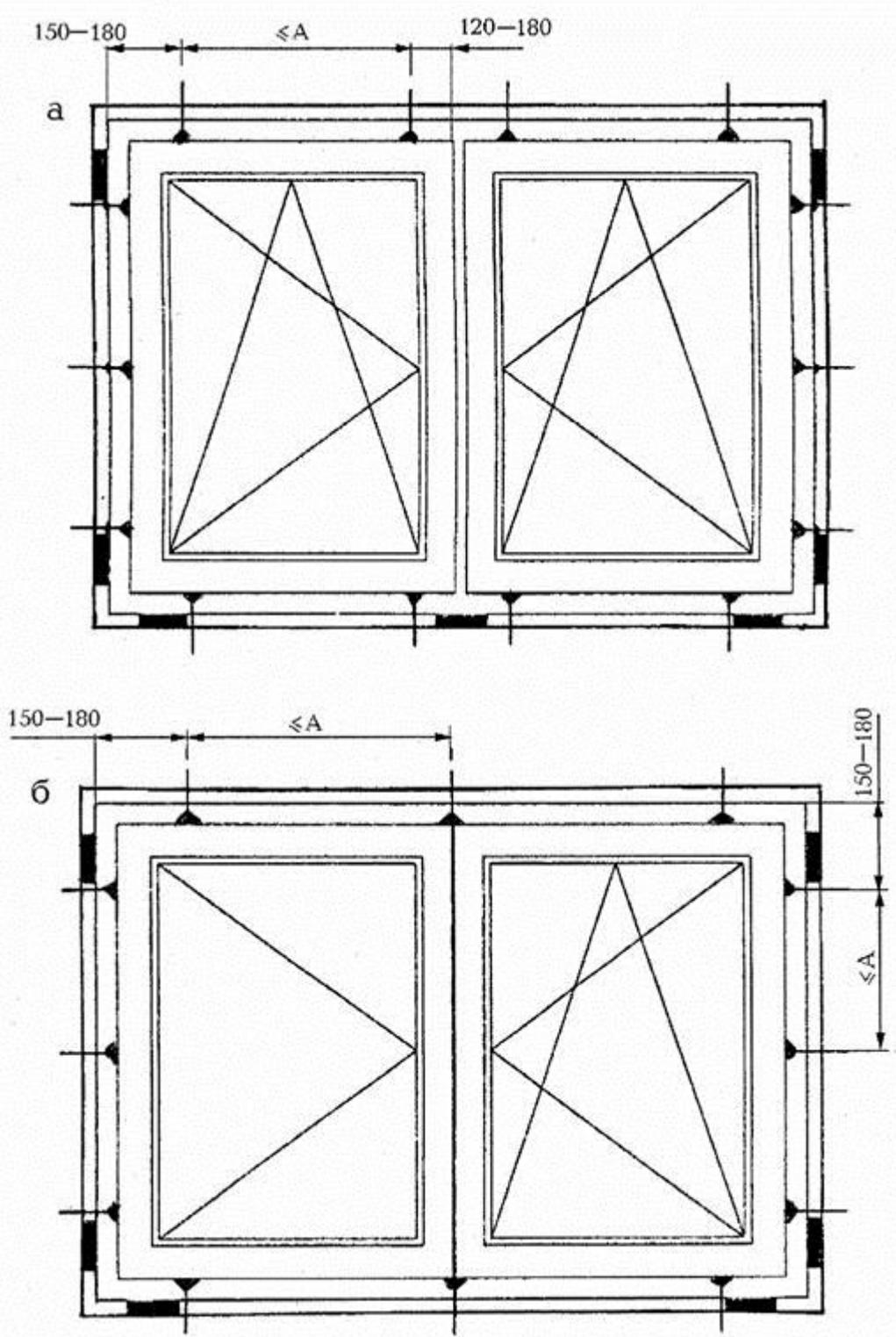
а – оконный блок с вертикальным импостом; б – оконный блок с безимпостным (штупльовым) притвором;
