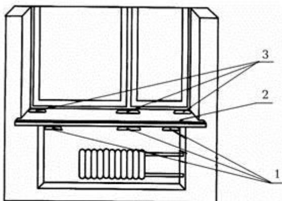
1 – канал подачи теплого воздуха от нагревательного прибора к оконному блоку (штроба в стяжке из штукатурного раствора); 2 – подоконная доска; 3 – декоративная решетка выходного отверстия
