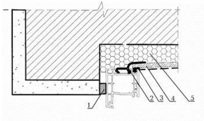
1 – изоляционная саморасширяющаяся паропроницаемая лента; 2 – дополнительный профиль; 3 – герметик; 4 – влагостойкий гипсокартон с пароизоляционным покрытием; 5 – пенный утеплитель
