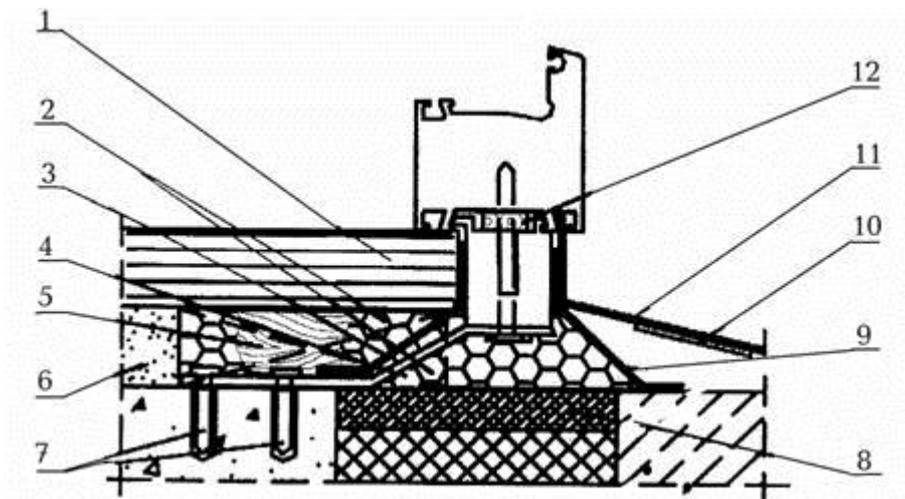
1 – подоконная доска; 2 – пенный утеплитель; 3 – пароизоляционная лента; 4 – гибкая анкерная пластина; 5 – опорная колодка под подоконную доску; 6 – штукатурный раствор; 7 – дюбель со стопорным шурупом; 8 – вкладыш из антисептированного пиломатериала; 9 – водоизоляционная паропроницаемая лента; 10 – шумопоглощающая прокладка; 11 – слив; 12 – изоляционная саморасширяющаяся паропроницаемая лента
