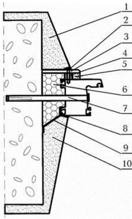
1 – штукатурный слой наружного откоса (с фаской для слоя герметика); 2, 8 – герметик; 3 – нащельник; 4 – дистанционная прокладка (шайба); 5 – изоляционная саморасширяющаяся паропроницаемая лента; 6 – пенный утеплитель; 7 – рамный дюбель; 9 – пароизоляционная лента; 10 – штукатурный слой внутреннего откоса (с фаской для слоя герметика)
