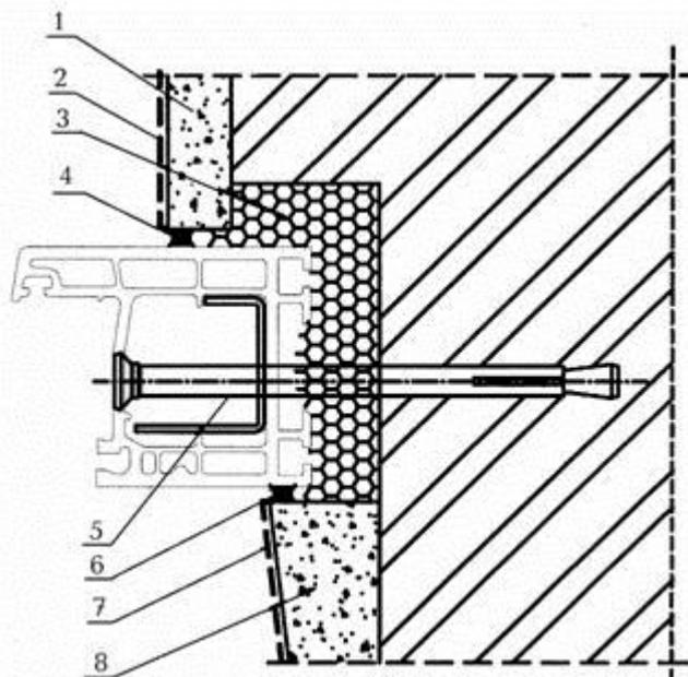
1 – отделка наружного откоса штукатурным раствором с коэффициентом паропроницаемости в соответствии с требованиями настоящего стандарта; 2 – паропроницаемая фасадная окраска; 3 – пенный утеплитель; 4, 6 – герметик; 5 – рамный дюбель; 7 – окрасочная пароизоляция; 8 – слой штукатурного раствора с высоким коэффициентом сопротивления паропропусканию
