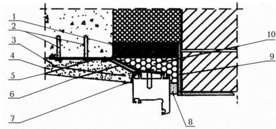
1 – вкладыш из антисептированного пиломатериала; 2 – дюбель со стопорным шурупом; 3 – армирующая сетка; 4 – штукатурный слой внутреннего откоса (с фаской для слоя герметика), возможна отделка листовым материалом (влагостойкая панель); 5 – гибкая анкерная пластина; 6 – пароизоляционная лента; 7 – герметик; 8 – изоляционная саморасширяющаяся паропроницаемая лента; 9 – стальная перемычка с антикоррозионным покрытием; 10 – пенный утеплитель;
