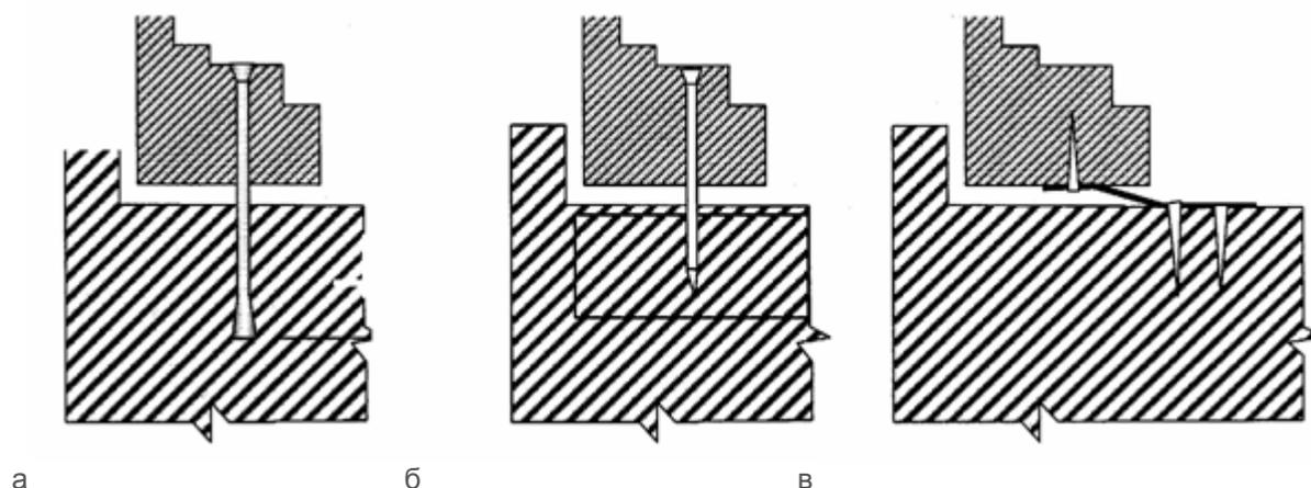
а – крепление распорными равными дюбелями; б – крепление строительными шурупами; в – крепление при помощи гибких анкерных пластин
