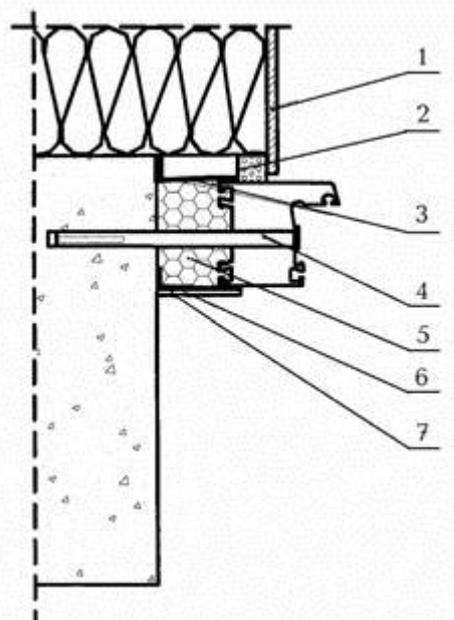
1 – элемент отделки наружного оконного откоса; 2 – изоляционная саморасширяющаяся паропроницаемая лента; 3 – водоизоляционная паропроницаемая лента; 4 – рамный дюбель; 5 – пенный утеплитель; 6 – пароизоляционная лента; 7 – декоративный нащельник
