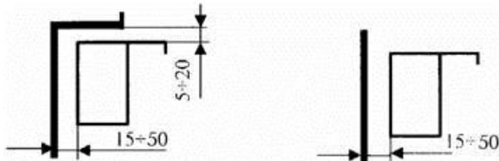
а) оконные блоки из алюминиевых сплавов при размере стороны до 2000 мм
