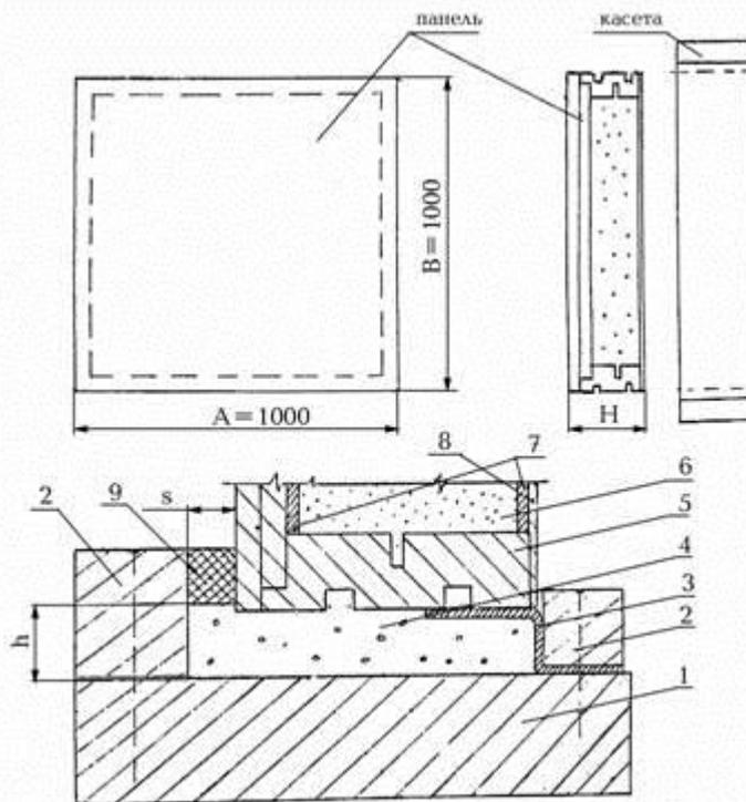
A, B, H – размеры панели, s, h – размеры зазоров под монтажный шов;
