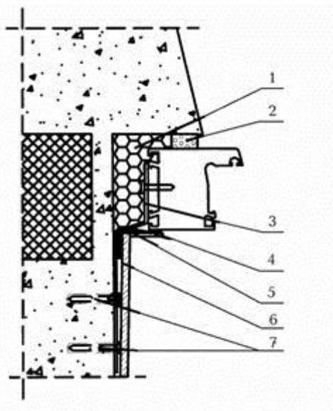
1 – пенный утеплитель; 2 – изоляционная саморасширяющаяся паропроницаемая лента; 3 – гибкая анкерная пластина; 4 – декоративный нащельник; 5 – пароизоляционная лента; 6 – элемент отделки внутреннего откоса; 7 – дюбель со стопорным шурупом
